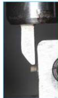
Εικόνα 2. : Ακρία άσπασης διατμητικών τάσεων
