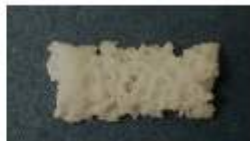
Εικόνα 3: Αφρός υδροξυαπατίτη με τη μέθοδο gel casting.
