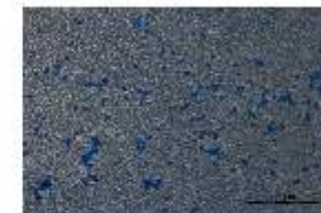
Εικόνα 3. Εικόνα SEM PVA:PEDOT:PSS (93:7) στις 3 και 6 ημέρες με παρουσία κυττάρων L929
