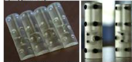
Εικόνα 2: Ρητινούχα καλούπια για την κατασκευή μοσχεύματος για την αντικατάσταση φθαρμένου τμήματος κρανιακού οστού.
